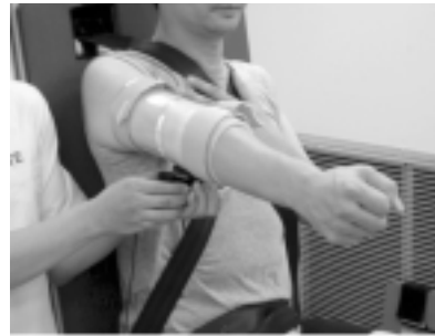
Fig.7 肩関節伸展トルク計測
